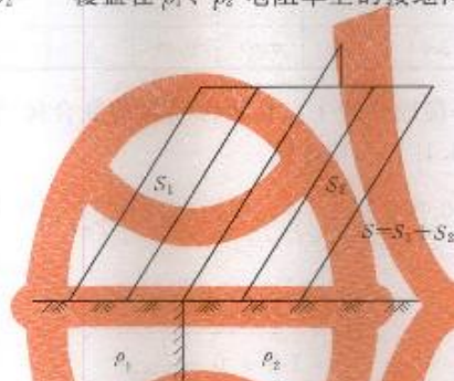
图 6.1.2-1 两种土壤电阻率的接地网
