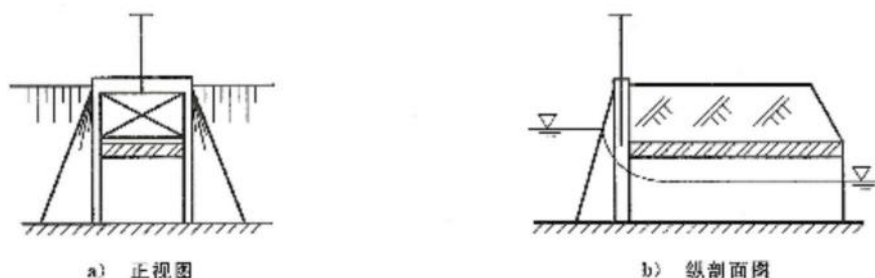
图3 矩形暗涵直立式单孔平板闸示意图
