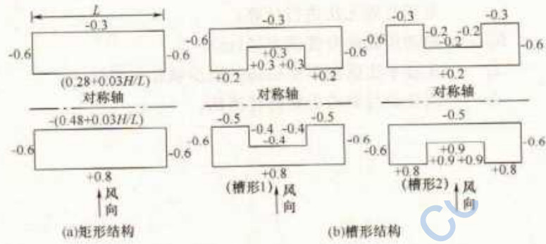
图 B.0.1 风荷载体形系数图
