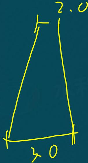
解析：心墙自上而下逐渐加厚，两侧边坡一般在1:0.30—1:0.15，顶部厚度按构造和施工要求常不小于2.0 m，底部厚度根据土料的允许渗透坡降来定，应不小于3 m。心墙与上下游坝体之间应设置反滤层，以起反滤和排水作用。
