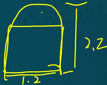
解析：坝体检修和排水廊道。为了便于检查坝体和排除坝体渗水，在靠近坝体上游面沿高度每隔15 ~ 30m设一检查兼作排水用的廊道。廊道断面形式多为城门洞形，廊道最小宽度为1.2m，高度2.2m。
