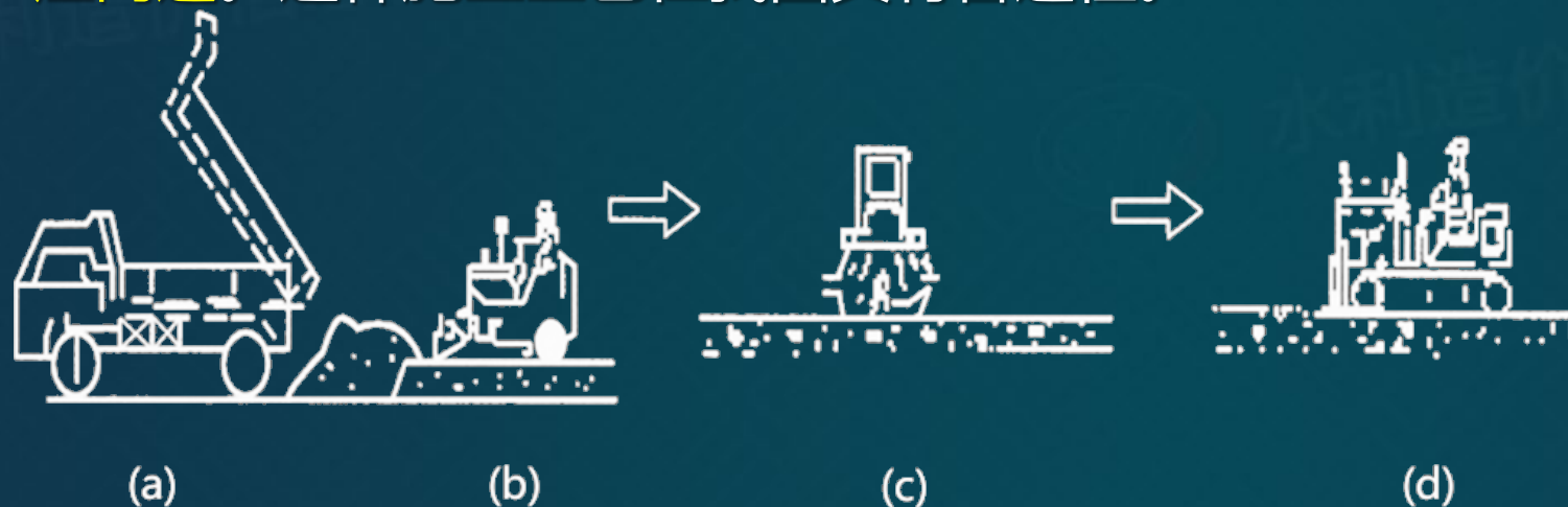
图1F416041 碾压混凝土坝施工工艺流程图
