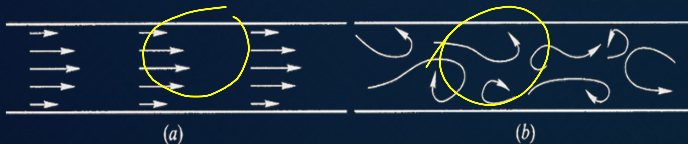
图 1F411029-4 层流与紊流示意图
