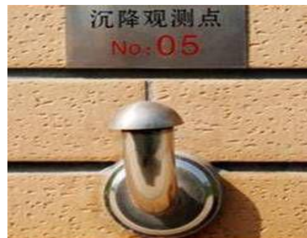
构筑物沉降监测实例图
