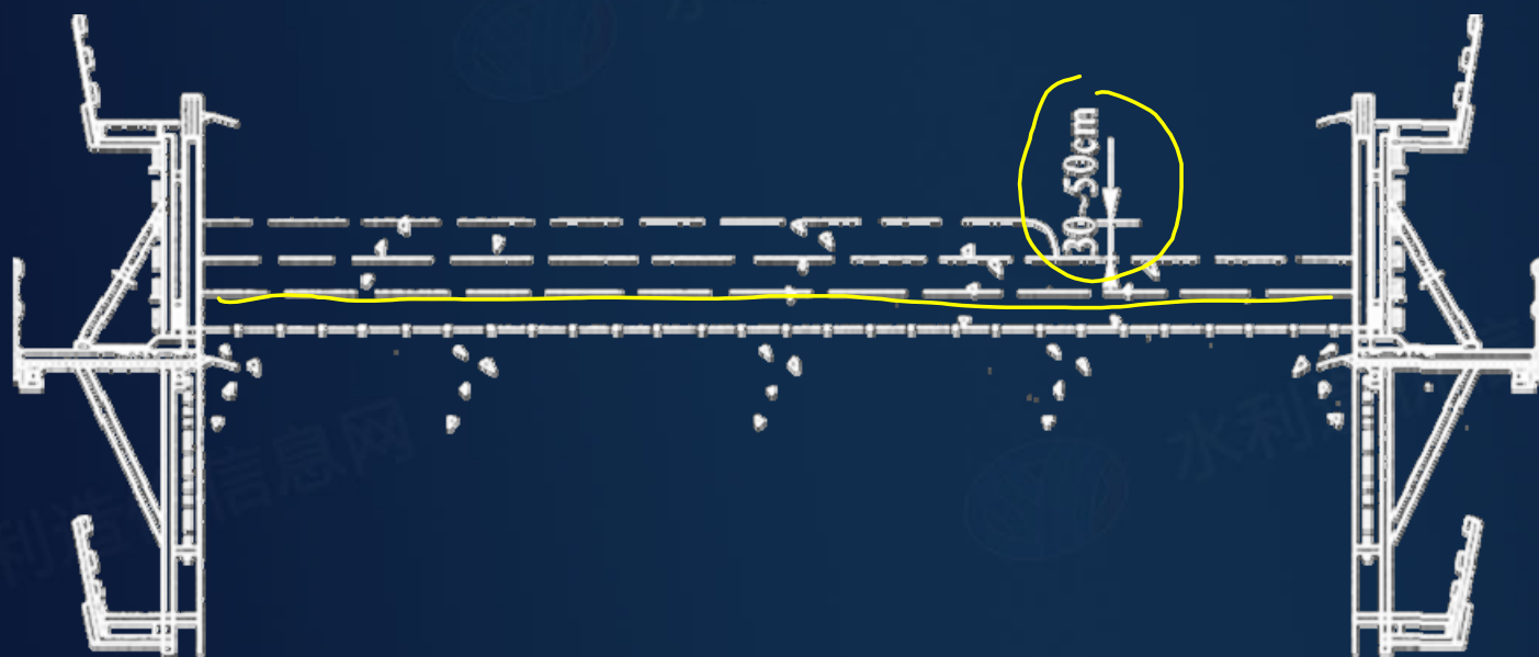
图1F416032-1 混凝土浇筑平铺法铺料
