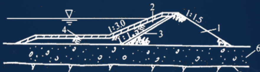
(b) 斜墙带水平铺盖式
