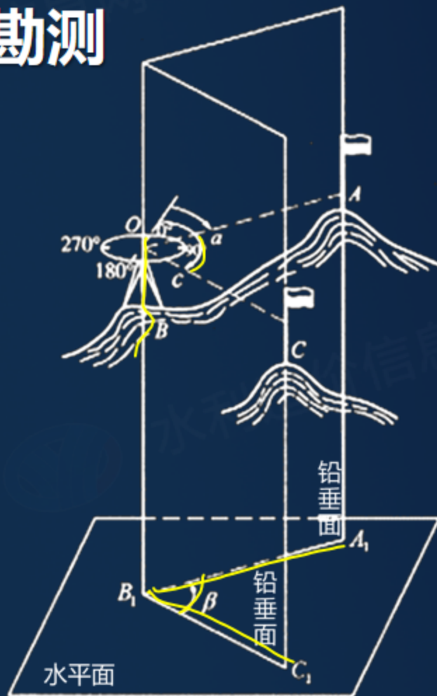
水平角测量原理
