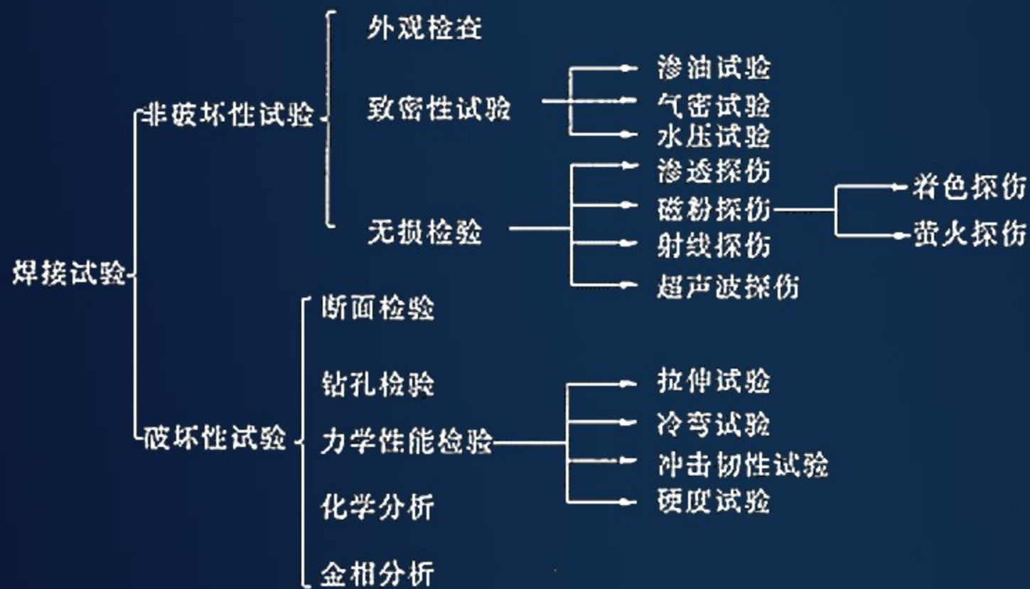
图 4-3-2 焊缝质量检验方法
